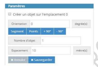
Le clic sur la carte marque le point d'origine. L'objet ponctuel voulu se positionnera alors conformément à la configuration de la fenêtre Paramètres, avec l'angle renseigné (ici 0 degré) et à 10 mètres du point d'origine.
